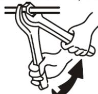
Рис. 5.2 Затяжка конусной гайки.
