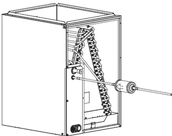
**Рис. 3 – Фильтр-осушитель жидкостной линии, установленный на наружном агрегате**
